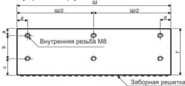
Вид устройства сверху – потолочный монтаж
