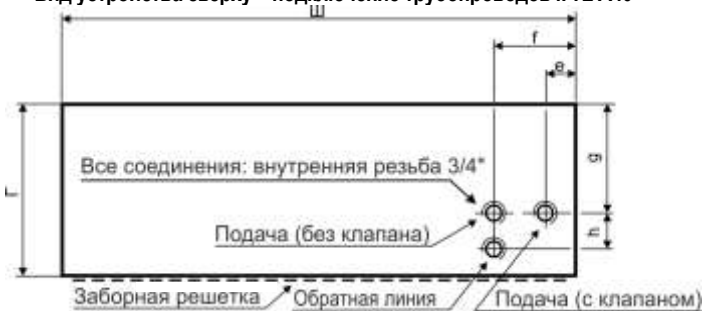
Вид устройства сверху – подключение трубопроводов к TL A40
