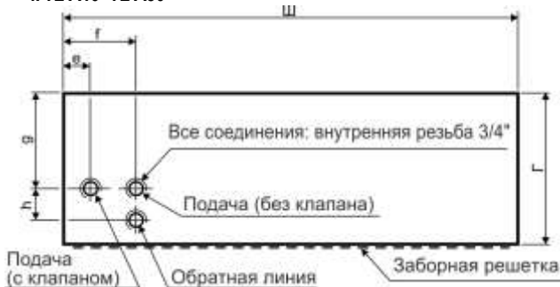
Вид устройства сверху – подключение трубопроводов к TL A40
